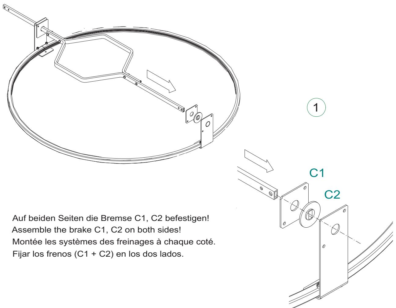
Auf beiden Seiten die Bremse C1, C2 befestigen!
