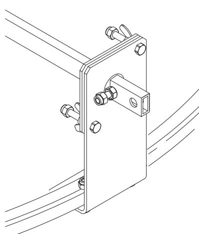
Die Bremswirkung wird durch Drehen der Flügelmutter eingestellt.
