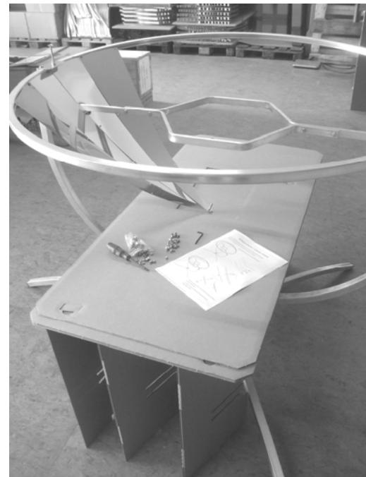
Ziehen Sie bitte die Schutzfolie ab, bevor Sie die Reflektorbleche anbringen!
