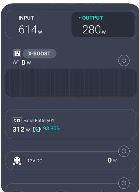
Auf der Registerkarte "Ausgang" werden die Gesamtausgangsleistung des Geräts und die Details der einzelnen Ausgangsanschlüsse angezeigt, einschließlich der Nutzung der AC-Stromversorgung, der 12V-Gleichstromversorgung und der USB-Anschlüsse. Sie können auch die AC-Stromversorgung, die 12V DC-Stromversorgung und die USB-Anschlüsse ein- und ausschalten. (Die Steuerung der USB-Anschlüsse ist bei bestimmten Modellen möglich.) Bei Verwendung der AC-Stromversorgung zeigt die Leistungskurve
