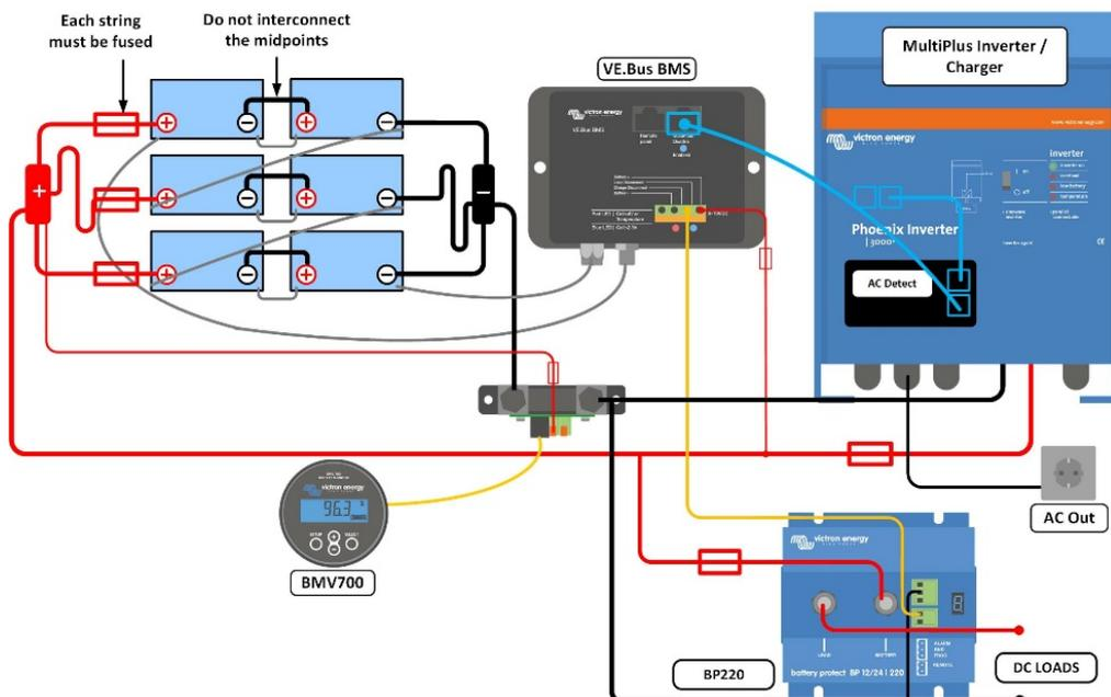
Unsere LFP-Batterien verfügen über eine integrierte Zellenausgleichs- und über eine Zellenüberwachungsfunktion. Es lassen sich bis zu 5 Batterien parallel und bis zu vier Batterien in Reihe schalten, sodass sich eine 48 V Batteriebank mit bis zu 1500 Ah zusammenbauen lässt. Die Kabel der Zellenausgleichs-/Überwachungsfunktion lassen sich miteinander verketteten und müssen an ein Batterie-Management-System (BMS) angeschlossen werden.
