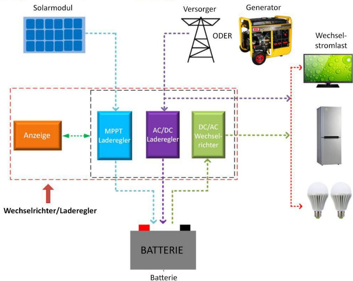
Achtung: Überprüfen Sie, ob die AC Ladeleistung mit der Leistung des Wechselrichters/Reglers übereinstimmen. Die gewählte AC Last darf nicht die maximale Ausgangsleistung des Wechselrichters/Reglers übersteigen.
