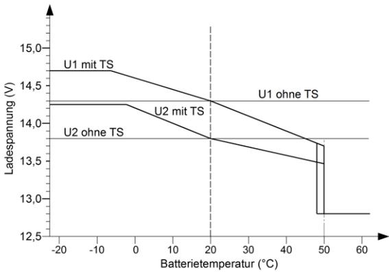
TS = bei Verwendung eines Temperatur-Sensors
